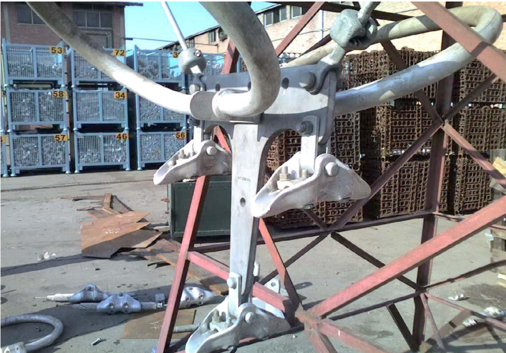
( استفاده از ۴۱ شکل , Socket Clevis , Yoke Plate , Arcing Rocket , Suspension Hinge ,
