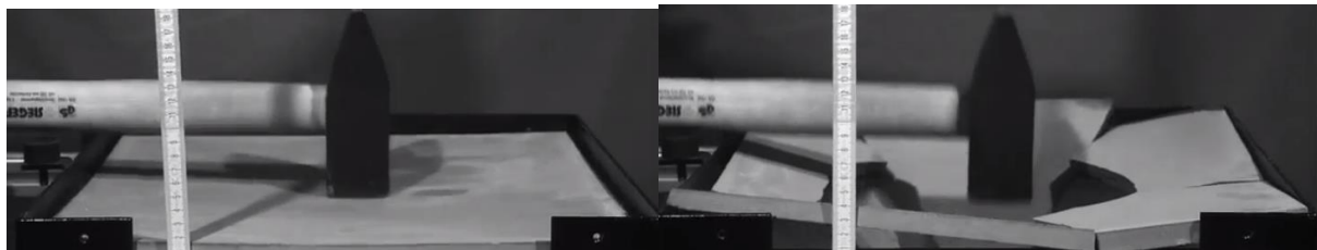
شکل (۱) طرز قرارگیری نمونه و آزمایش ضربه ای بدون الیاف شکل (۲) طرز قرار گیری نمونه و آزمایش ضربه ای با الیاف
