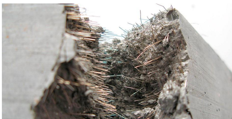
شکل (۵) نمونه نهایی بتن همراه با الیاف فولادی
